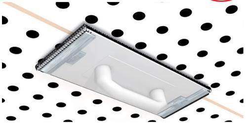
Bei Lochgipsdecken mit 4-seitig scharfkantiger Ausführung (Kante 4SK) ohne Fase muss ein ca. 2 mm großer Abstand (z.B. mittels Montagehilfe für Lochplatten) zwischen den Platten, angepasst auf das Lochbild, eingehalten werden. Somit ist gewährleistet, dass ausreichend Spachtelmasse in die Fugen eingebracht werden kann.
