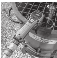
Appendere l'apparecchio al secchio del miscelatore
